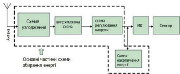
Рис. 1. Структура ректени з корисним навантаженням у вигляді мікроконтролера та сенсора
